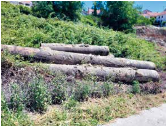
Извађене из тила цијеви старог челичног цјевовода ДН 600 мм и изјед у појечном пресеку
