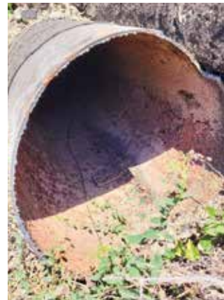
Извађене из тила цијеви старог челичног цјевовода ДН 600 мм и изјед у појечном пресеку
